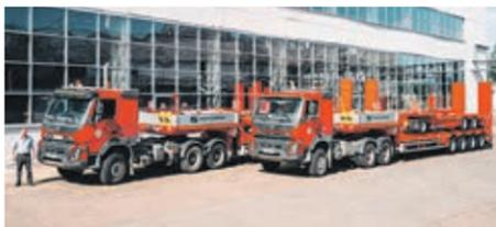
Автопарк Пинежского ЛПХ продолжает пополняться новой техникой. В подразделение поступили четыре тяжеловозных траля, сконструированных по специальному заказу Группы компаний УЛК. Они оборудованы усиленной пневматической подвеской, а также электронной тормозной системой последнего поколения. Траля будут осуществлять транспортировку крупногабаритной техники АТЦ, дорожной службы и лесозаготовительных комплексов.
